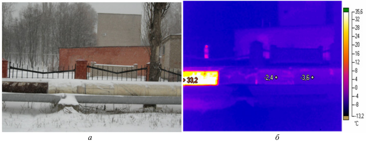
Рис. 1 – Ділянка трубопроводу з пошкодженою теплоізоляцією (а) та її термограма (б)
